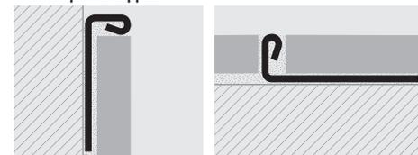
**PROTERMINAL** технический отделочный профиль. Используется, главным образом, для соединения одинаковых или различных материалов для пола (например, керамика/керамика - керамика / паркет/мрамор/ламинат/ковровое покрытие/ линолеум и т.д.) различной толщины. **PROTERMINAL** из латуни также используется для защиты ступенек лестниц и подножек, отделки полов и покрытия плинтуса, рабочих поверхностей, а также для обрамления ковриков у порога.
